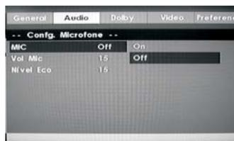
O microfone pode ser ativado («ON») ou desativado («OFF»). Quando ativado, o HT-725 detecta e corrige a entrada de voz. Quando desativado, o aparelho não reconhecerá o microfone. Escolha («ON») para o aparelho detectar automaticamente o uso do microfone.
